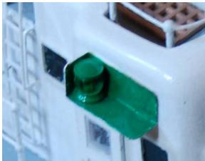
In dieser Positionslaterne ist die Glühlampe durch eine 3 mm Standard-LED ersetzt. Da die Laterne und das Blech aus Messing sind, ist auf die Isolation der Anschlüsse zu achten.
