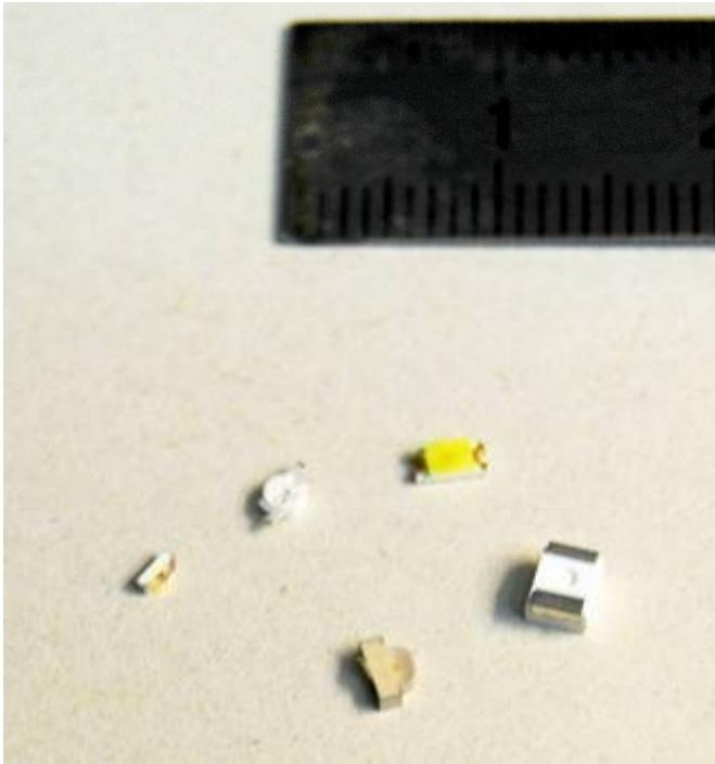
Sie müssen allerdings in der Regel selbst bedrahtet werden. Hierzu sollte man sie gut fixieren. Für die Bedrahtung eignen sich je nach Einsatz Massivdrähte mit Durchmessern von etwa 0,6 mm (Achtung! Kurzschlüsse beim Einbau vermeiden) oder Litzen mit 0,05 mm<sup>2</sup> Querschnitt und Aussendurchmessern von 0,6 mm (Dekoderlitzen für Modelleisenbahnen).
