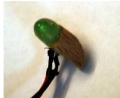
Zum Kleben und Vergiessen sind glasklarer 2-Komponentenkleber und Sekundenkleber gut zu verwenden.
