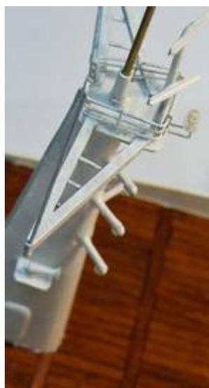
Hier eine LED-Beleuchtung für ein Schiff im Massstab 1:100. Am Mast befinden sich 3 rote und 2 weisse LEDs. Die Halter haben einen Durchmesser von 2 mm
