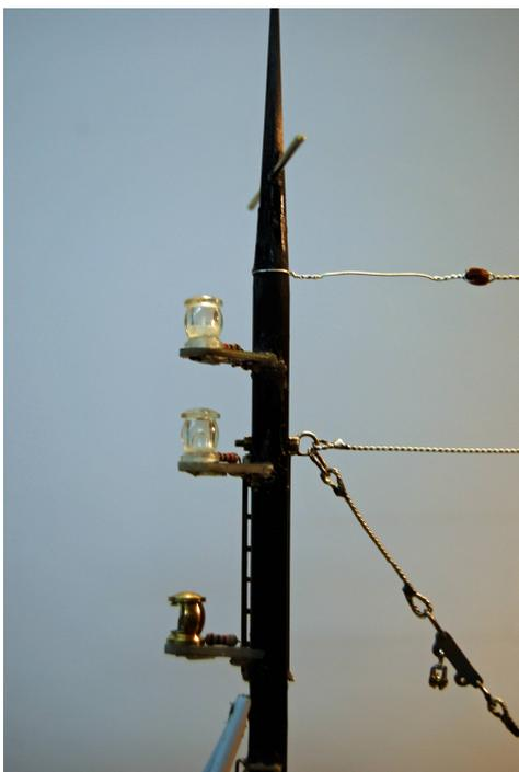
Bei der Mastbeleuchtung finden ebenfalls 3 mm Standard-LEDs ihren Einsatz, sie sind auf eine kleine Platine gelötet, die an den Mast geklebt ist. Auch der Vorwiderstand hat hierauf seinen Platz gefunden.
