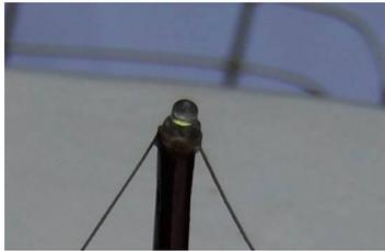
Toplicht mit weisser LED direkt auf dem Mast befestigt, 3 mm Durchmesser
