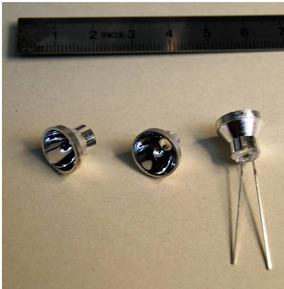
Mit Hilfe von Reflektoren und weissen LEDs lassen sich recht einfach Leuchten und Scheinwerfer bauen. (lieferbar für 3 und 5 mm LEDs)
