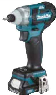
**TD111DZJ****TD111DSMJ 4.0 Ah****Drehzahl** 0-1'300/0-3'000 **Aufnahme** 1/4"**Schläge** 0-1'600/0-3'900 **Drehmoment** 135 Nm**Standard M5-M14** **Gewicht** 1.2 kg**TL064D**
