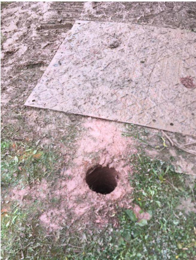
Abbildung 6: Bodenbohrung, Quelle Lena Hörner
