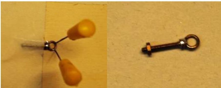
Bild 6: links: vor dem Verlöten die Teile fixieren, rechts die fertige Ringschraube M 1,4
