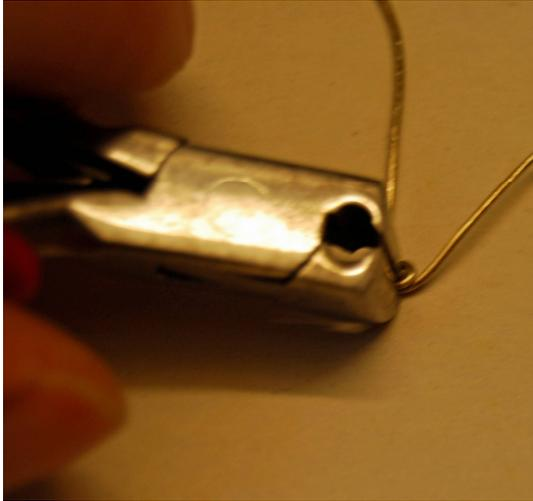
Bild 4: Arbeitsschritt 2, überflüssige Enden Abschneiden
