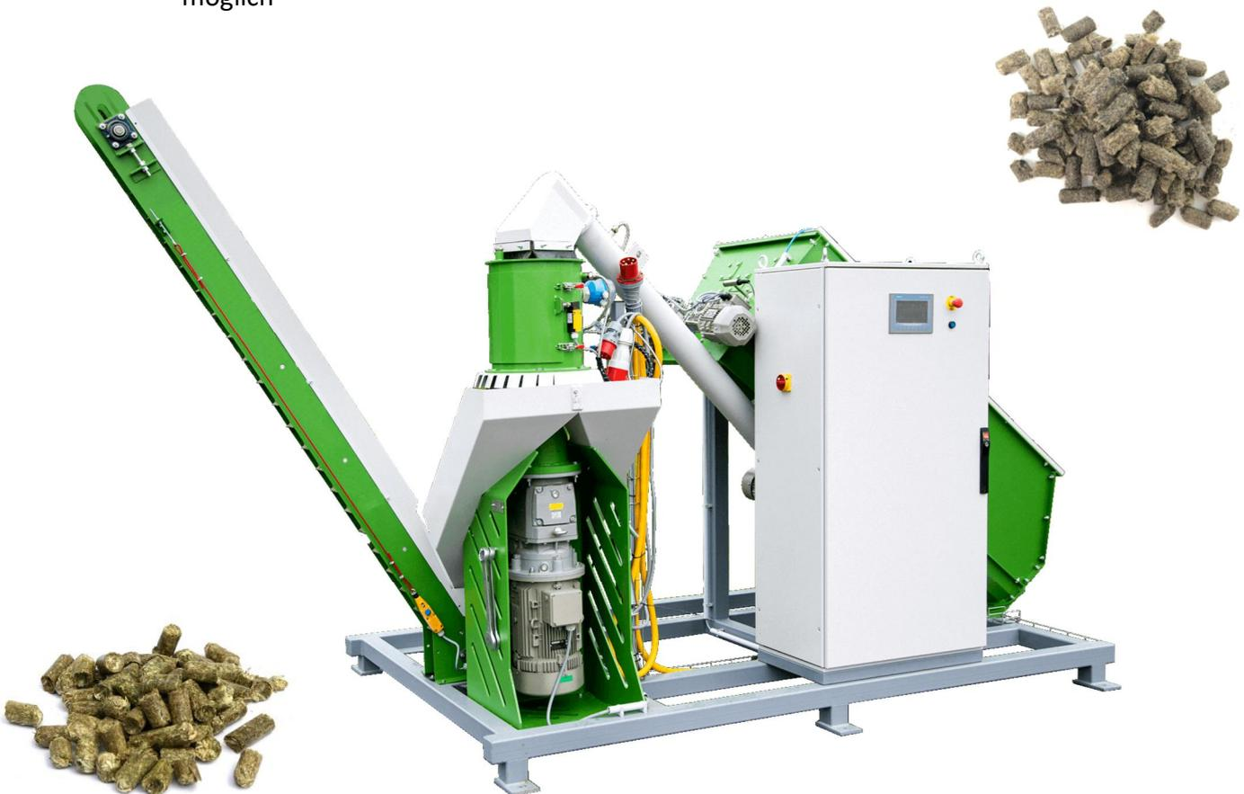
Die **Presse** ist in den Leistungsklassen 11 kW, 15 kW und 30 kW erhältlich. Unterschiedliche Matrizen ermöglichen nicht nur versch. Ausgangsmaterialien zu verarbeiten, sondern auch den Durchmesser der fertigen Pellets zu variieren und das Schüttgewicht zu beeinflussen.
