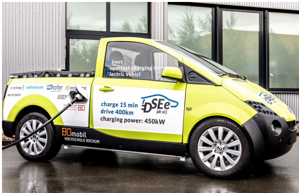
Abbildung 1: Das BOmobil wurde eigens für das Forschungsprojekt „D-SEe“ mit einer neuen und leistungsstarken Batterie ausgerüstet, um den Schnellladevorgang von 15 Minuten für 400 km Reichweite zu ermöglichen.
