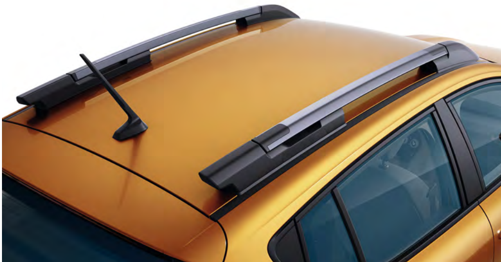
MODULARE DACHRELING (HIER: IN LÄNGSRICHTUNG)
