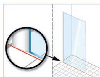
Die **Außenkante des Profils** verläuft entlang der Fliesenfuge (Sondermaß).
