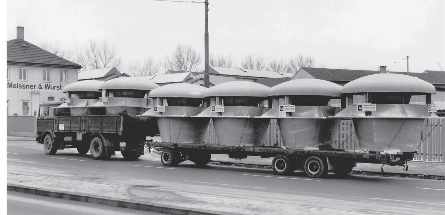
Rain-proof sound damping equipment for nuclear power plant, Biblis, Germany, 1971. Schalldämpfer-Diffusor mit Regenhaube für das Kernkraftwerk in Biblis, 1971.
