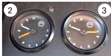
Druckluft ergänzt, Federspeicher gelöst
