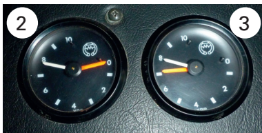
Druckluft ergänzt, Federspeicher angezogen
