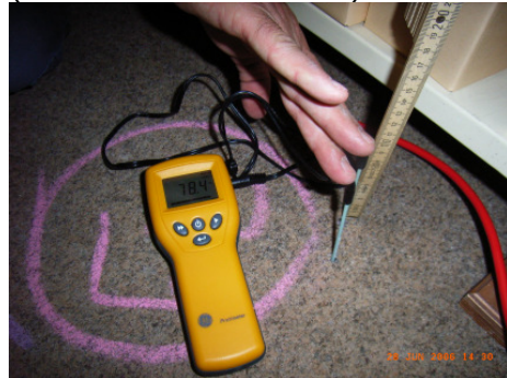
Bild 7, Ermittlung der Bauteilfeuchtigkeit mittels Tiefenmeßsonden (Foto aus anderem Vorhaben)
