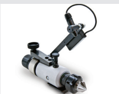
Senker- und Fräuserschleifvorrichtung SZVR Art.-Nr. 11280 für dreischneidige Kegelsenker von 6-31 mm oder bis MK3, sowie für ein- bis vierschneidige Fräser zum stirnseitigen Anschleifen bis 20 mm. inkl. 10 mm Spannzange
