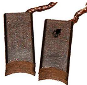
Eingelaufene Kohlekontakte => max. Auflagefläche
