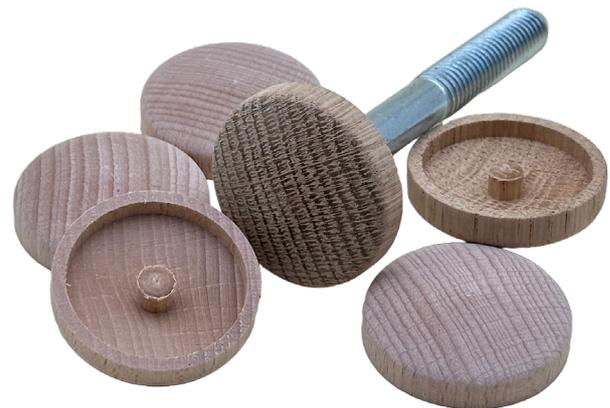
Abdeckkappen aus Hirnholz, mit **Innenzapfen Ø 4,2 mm** für Sonder-Treppenbauschrauben, in allen europäischen Holzarten, maschinenfallend, Schraubenkopf-Ø 14,5 mm, Außen-Ø 20 mm,
