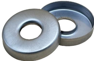
Wandrosetten aus Edelstahlblech 0,8 mm, Werkstoff 1.4301, Oberfläche Längsschliff Korn 240, Außen-Ø 44 mm, Dicke 8,3 mm, für Stufenbolzen Ø 16 mm, **VPE 50 Stück**
