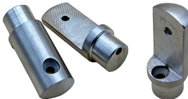
Stufenauflegebolzen, fein gedreht, Bolzen- $\varnothing 16$  mm, beidseitig gefast, Gesamtlänge 130 mm, Bolzenlänge 75 mm, Auflagefläche 50 mm, Sicherung mit 5 mm Spaxschraube, VPE 50 Stück
