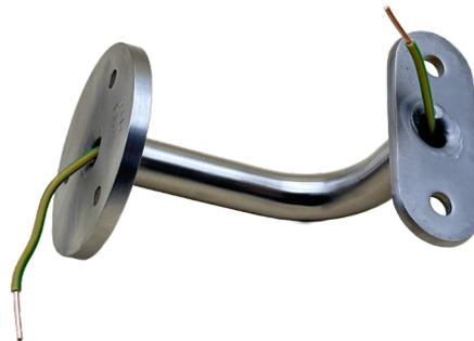
Formschöner Wand-Handlaufhalter, aus Edelstahl, Material 1.4305, Ø 16 mm, inkl. Wandscheibe Ø 40 mm und Montageset (Stockschraube M10 x 80 mm, Flossendübel Ø 12 x 70 mm + Spaxschraube für Holzhandläufe)
