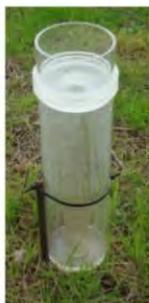
a) Pluviómetro manual
