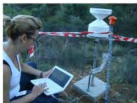
b) Pluviómetro automático
