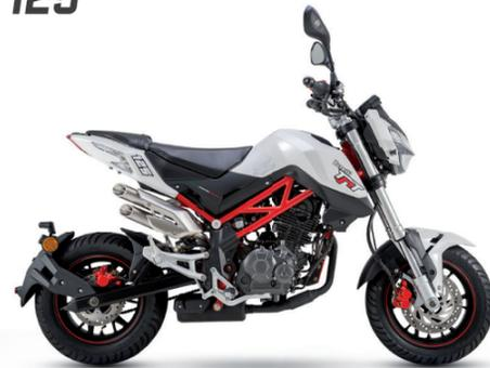
**MOTORTYP:** Luftgekühlter 4-Takt Ein-Zylinder Motor, SOHC (single overhead camshaft),
