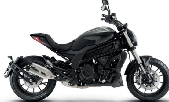
**MOTORTYP:** Flüssigkeitsgekühlter 4-Takt Zwei-Zylinder Reihenmotor, DOHC (double overhead camshaft),
