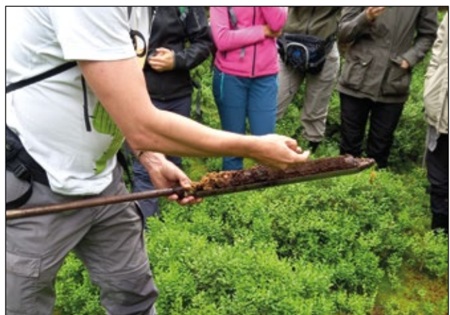
Abb. 7: Durch Bohrkernentnahmen ist im Tannermoor eine Torfmächtigkeit von über acht Metern belegt. Im Bild eine Entnahme der oberen Bodenschicht. Foto: MVA – Andreas Hunger
