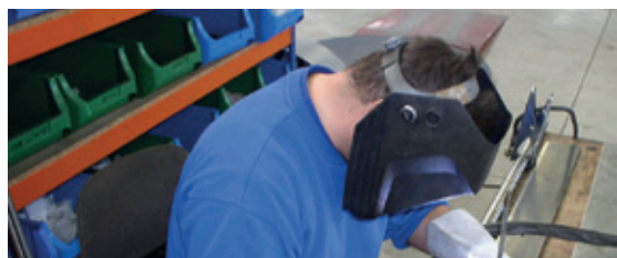
WIG-Schweißen von Sonderteilen, Fenstergittern und kompletten Geländern durch speziell ausgebildete Mitarbeiter.
