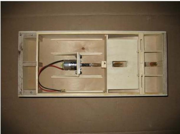
Motorträger und Motor montiert (1)
