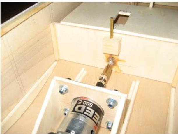
Motorträger und Motor montiert (3)
