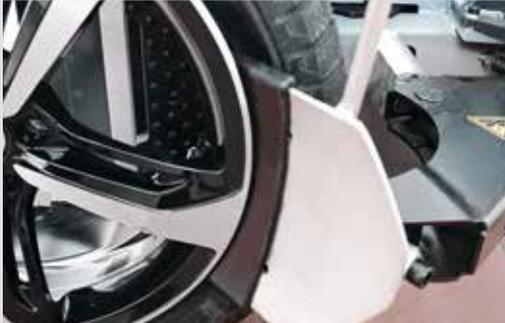
1. Beim Montieren oder Demontieren von Runflat- oder Niederquerschnittreifen ist es wichtig, den Abstandshalter für die Reifenschaufel zu verwenden. Drücken Sie beim Abdrücken des Reifenfuß nicht zu fest auf die Seitenwand des Reifens. Achten Sie darauf, dass das Ventil sich in einer h6- oder h12-Position befindet, bevor Sie den Reifenfuß öffnen, um schwere Schäden am Produkt zu vermeiden.
