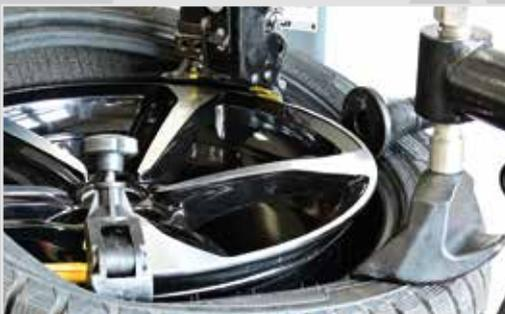
4. Beim Montieren des Reifens auf die Felge ist zu beachten, dass alle drei Druckpunkte korrekt platziert werden. Der Kunststoff-Felgenschutz muss vor dem ersten Druckpunkt angebracht sein. Für eine reibungslose Montage ist es wichtig, dass eine ausreichende Menge an Reifenmontagepaste verwendet wird.
