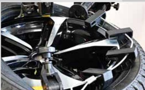
5. Der Wulst-Niederhalter ist ein nützliches Hilfsmittel bei der Montage von Felgen. Mit der Wulstrolle lässt sich der Reifen unter dem Montagekopf einfach in Position bringen. Um den Prozess zu vereinfachen, sollten die Wulstdruckpunkte stückweise eingesetzt werden, nachdem die Druckpunktklemme und der Kunststoff-Felgenschutz platziert wurde.
