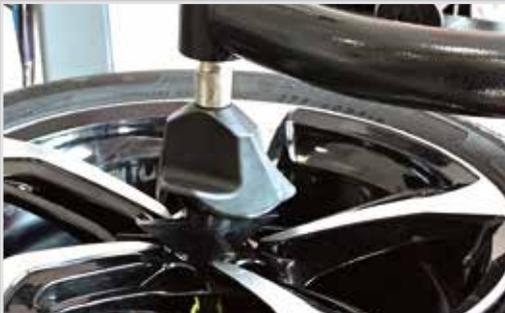
2. Für eine sichere und zuverlässige Montage von Runflat- und Niederquerschnittreifen sorgt der Zentrierkonus: Dieser wird entsprechend der Reifengröße vorpositioniert und übt dank seines Drucks die richtige Griffkraft auf die Felge aus, um sie mittels der Spannbacken zu fixieren.
