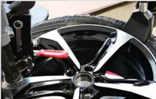
3. Entfernen Sie den oberen Teil des Reifenfuß mit einem Kunststoffhebel und einem Hilfsarm. Drücken Sie leicht den Reifen auf der gegenüberliegenden Seite nach unten, um die Spannung zu lösen. Stellen Sie sicher, dass sich der Reifenfuß im Felgenbett der Felge befindet und bewegen Sie den Drehteller langsam, während Sie den Hebel festhalten.
