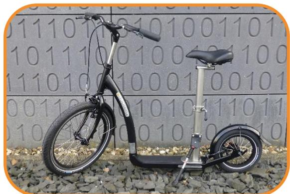
Anpassung am Wachstum des Kindes durch neue Sattelstütze möglich.
