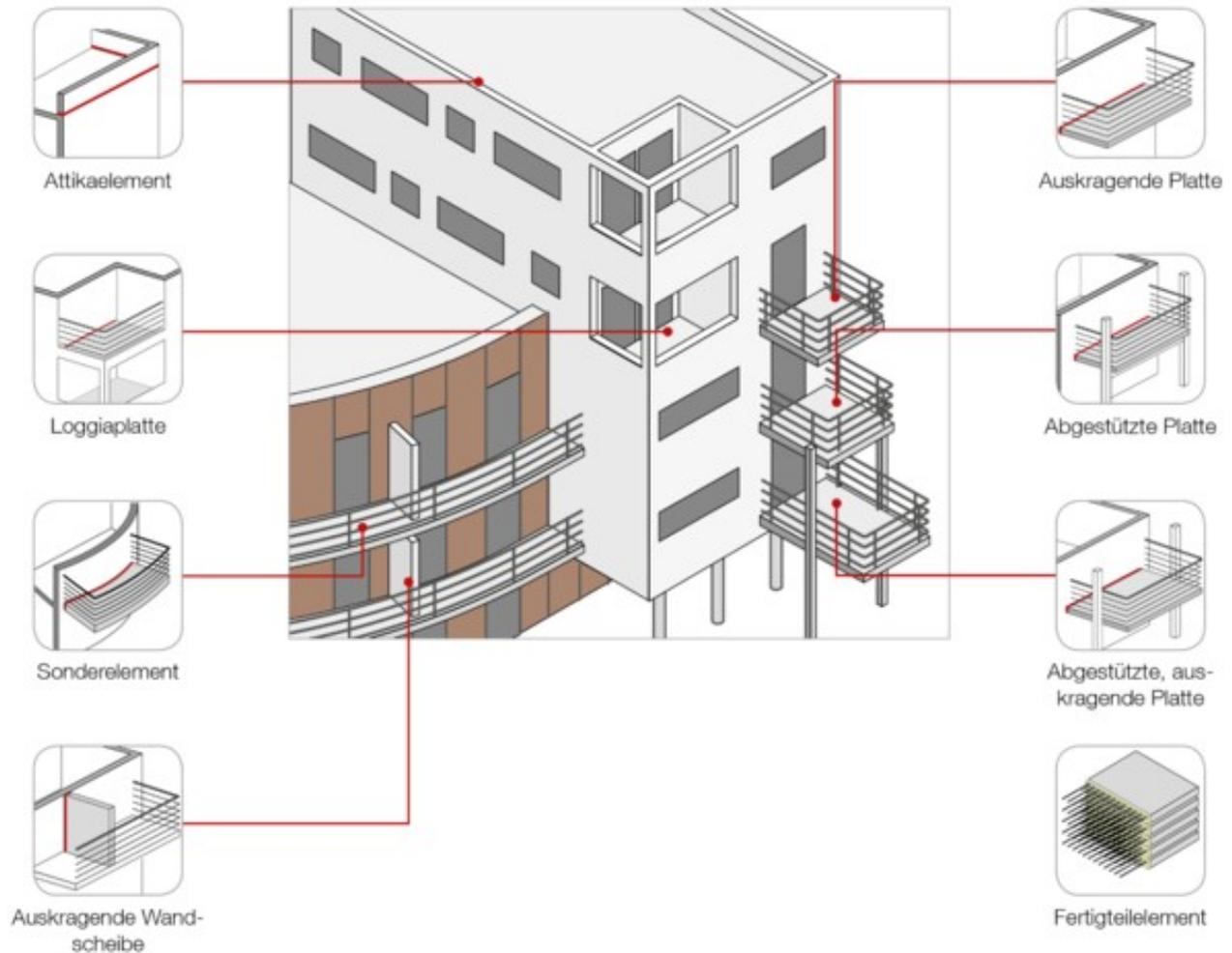
Die Anforderungen an einen Kragplattenanschluss sind so vielseitig wie seine Einsatzmöglichkeiten. Bei der Bemessung des Typ's werden folgende Bezeichnung benötigt.
