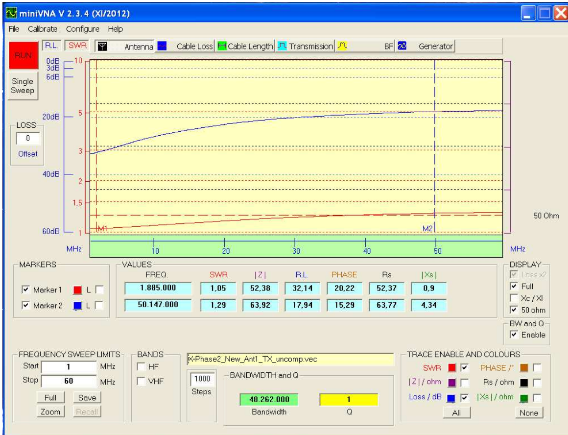
Bild 18: Das in der Betriebsart Senden mit einem VNA an der Ant 1-Buchse gemessene SWV
