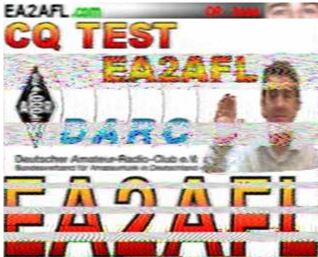
Bild 16: Ein im weißen Farbbereich mit einem S9-Störsignal gestörtes SSTV-Signal. Das X-Phase 2 -Gerät wurde um die Wirksamkeit zu demonstrieren, an den weißen Streifen im Bild zu erkennen, periodisch kurzzeitig ausgeschaltet.
