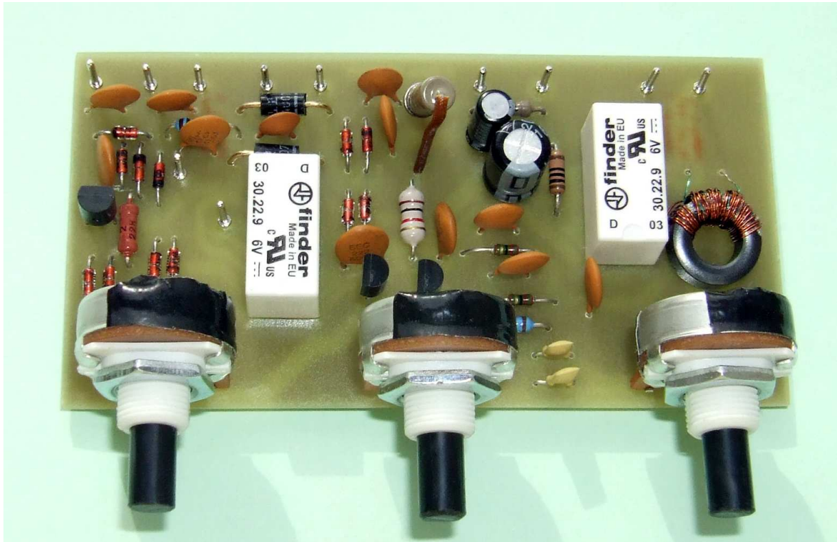
Bild 7: Blick auf die bestückte Platine; rechts im Vordergrund ist der Überträger ÜI zu erkennen.
