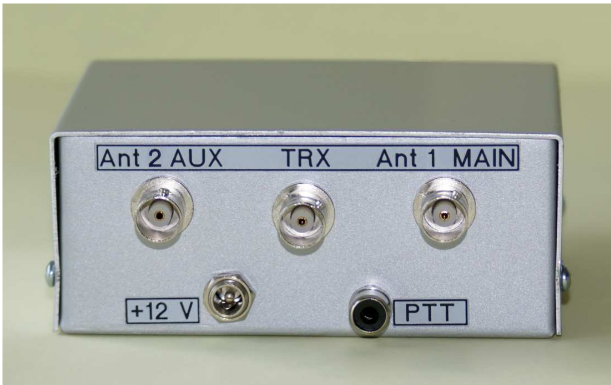
Bild 13: Die Gehäuse-Rückseite, hier mit BNC-Buchsen versehen
