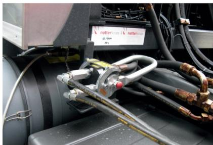
Abbildung 37 - Hydraulik angeschlossen am Trägerfahrzeug
