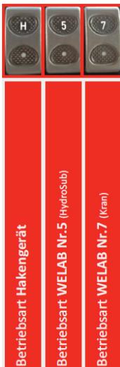
Figur 15- Nebenantriebsschalter Hakengerät
