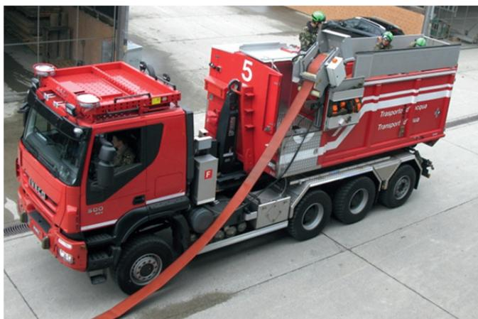
Abbildung 52 - Arbeit im Schlauchcontainer beim Schlauch aufnehmen
