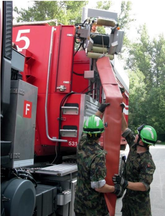
Abbildung 47 - Einführen des Transportschlauches in den Schlauchaufnehmer
