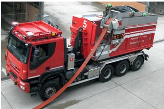
Abbildung 63 - System Schlauchaufnehmer
