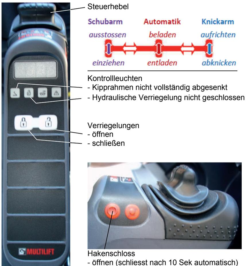
Figur 17 - Bedieneinheit zum Hakengerät MULTILIFT
