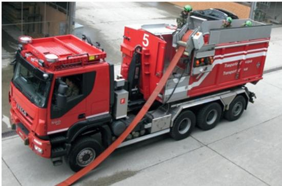
Abbildung 45 - System Schlauchaufnehmer
