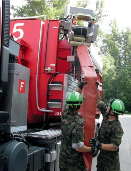
Abbildung 65 - Einführen des Transportschlauches in den Schlauchaufnehmer
