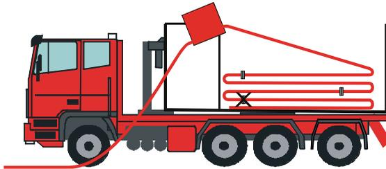
Abbildung 34 – Positionierung Schlauchkupplungen im Container
