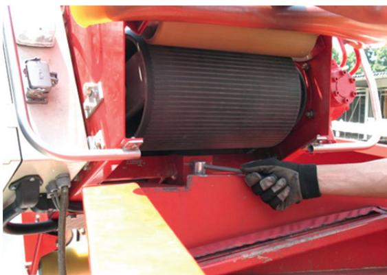
Abbildung 26 – Schlauchaufnehmer mittels Knebelschraube sichern
