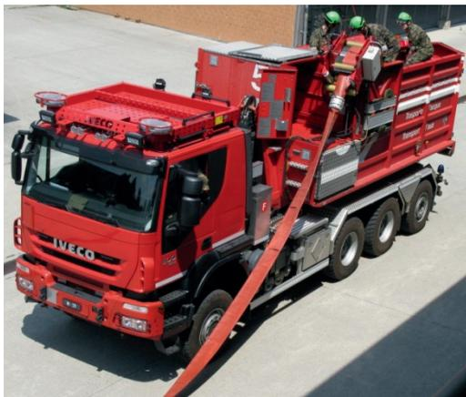
Abbildung 28 - System Schlauchaufnehmer
