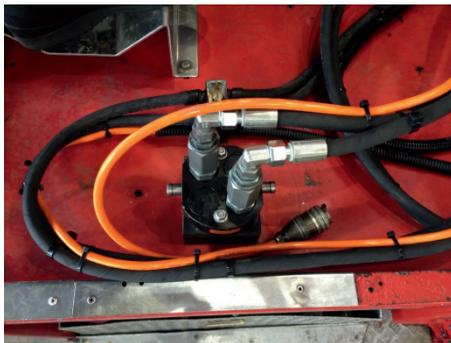
Abbildung 53 - Hydraulik-Kupplung versorgt
