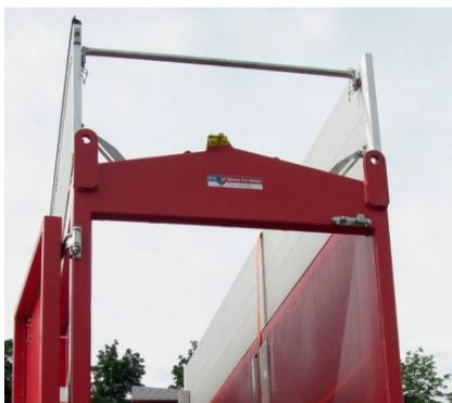
*Abbildung 56 - Gesicherter Deckel Schlauchcontainer*
