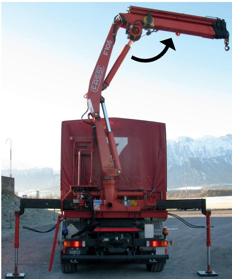
Abbildung 77 - Teleskoparm angehoben
