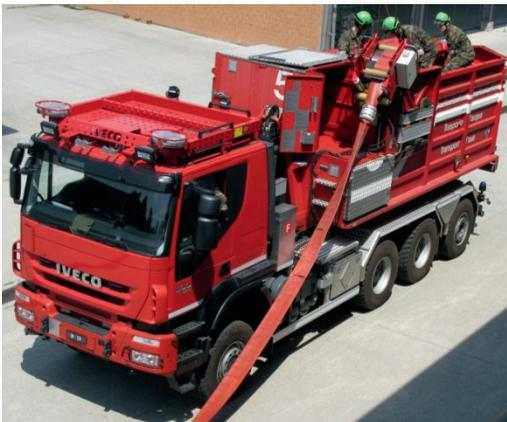
Abbildung 35 - Arbeit im Schlauchcontainer beim Schlauch aufnehmen
