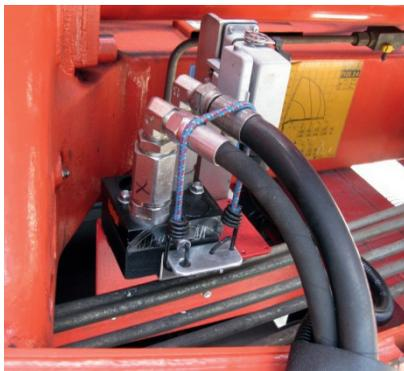
*Abbildung 87 - Versorgte und gesicherte Hydraulikschläuche und das Elektrokabel*
