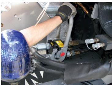
Figur 72 - Anschluss Hydraulikschlauchpaket
