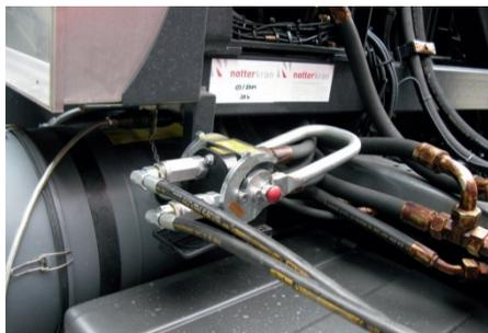
Abbildung 54 - Hydraulik angeschlossen am Trägerfahrzeug
