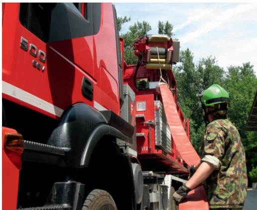
Abbildung 30 - Einführen des Transportschlauches in den Schlauchaufnehmer
