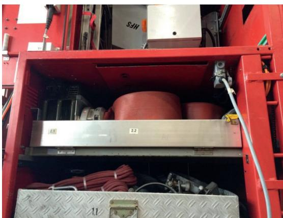
Abbildung 39 - Kabelanschluss für Inbetriebnahme Schlauchaufnehmer grau im Fach 2.2
