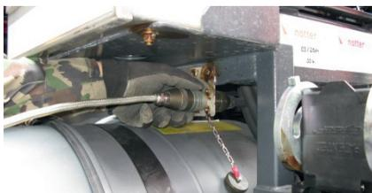
Abbildung 21 - Elektro-Anschluss am Trägerfahrzeug
