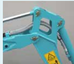
Löffelzylinderschlauch im Stiel
