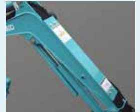
Schlauchschutzabdeckung auf der Rückseite des Auslegers
