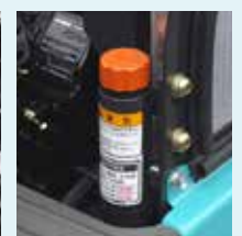
Hydrauliköl mit langer Lebensdauer und einem Wechsellzyklus von 1000 Stunden (Foto zeigt den Hydrauliköl-Einlass)
