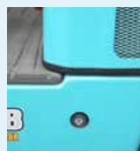
Leicht kontrollierbare Anzeige des Hydraulikölbehälters.
