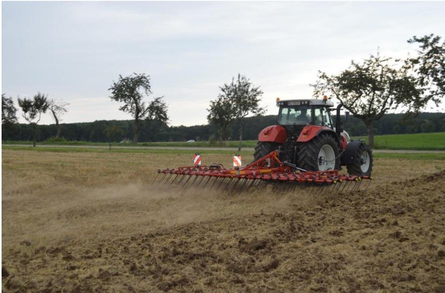
Schwerstriegel ermöglichen eine schonende und schnelle Überfahrt mit geringen Kosten (ca. 10 €/ha) und einer Bodenbearbeitung je nach Bodenart von 2 bis max. 4 cm Tiefe
