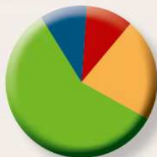
Hauptfaktoren sind Mechanik und Einwirkzeit, die Chemie und die Temperatur sind untergeordnet
