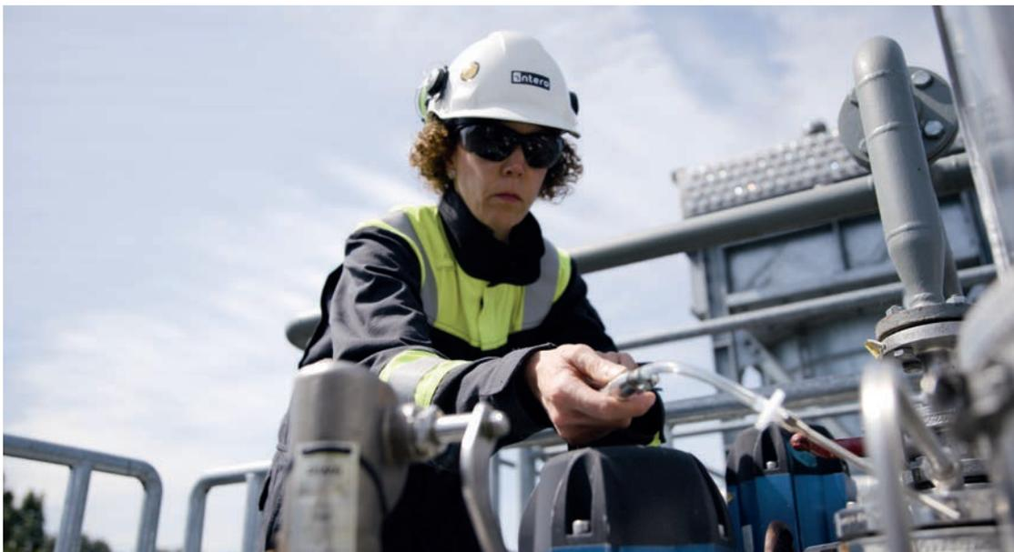
Mit einem Spezialgerät können geringste Methan-Emissionen aufgespürt werden, die aus Mikroleckagen entweichen. © Wintershall Dea
