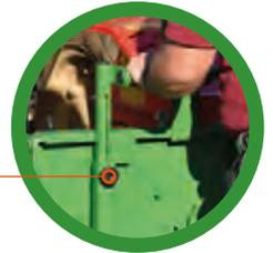
Roulements oscillants assemblés sur le milieu inférieur de la bascule
