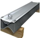
Aluminium Anschlageneinrichtung mit Edelstahl-Ringöse zur fixen Montage. Spezielle Form für Welleternit-Dächer (Wellenabstand 177mm). Befestigung mit vier Edelstahlschrauben in zwei Sparren. Die 125cm lange Grundplatte wird bei Bedarf vor Ort auf den jeweiligen Sparrenabstand gekürzt. Inkl. Befestigungsmaterial.
