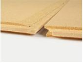
Ab 15° Dachneigung regensicher ohne zusätzliche Abklebung der Plattenstösse für 22, 28 + 35mm Plattendicke; ab 20° Dachneigung für 18mm Plattendicke.
