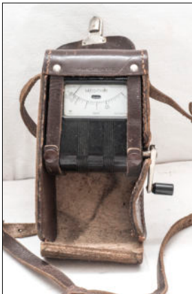
5166 Gossen Megohm, Isognom 500 V, Isolationsmesser, mit Kurbel, ca. 50er Jahre. Im Lederköcher. 0078500811
