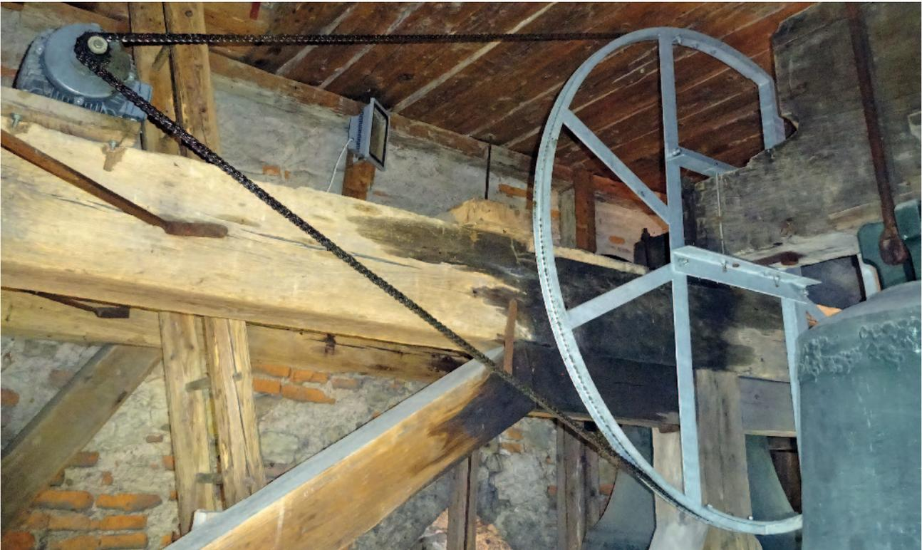
*Elektrischer Antrieb mit Zugrad bei der Martinusglocke*
