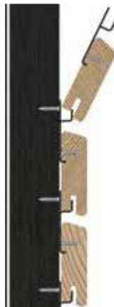
Fassadenbahn diffusionsoffen Konstruktionsholz schwarz eingefärbt Fassadenklammer Rautenleiste (unsichtbar verschraubt)
