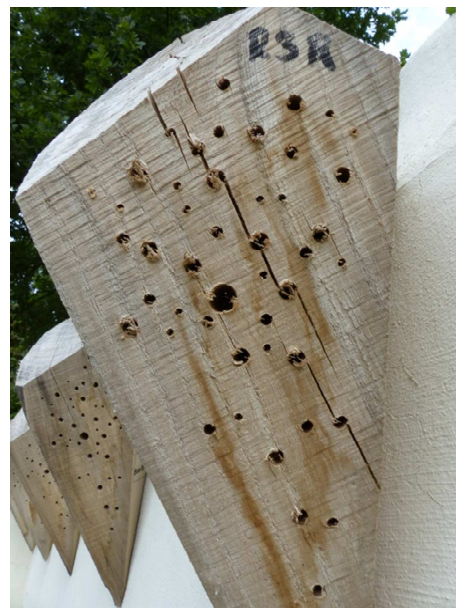
Figuur 5. Door barsten in de bijenhotels waren sommige gaten niet meer geschikt voor bewoning door bijen.
