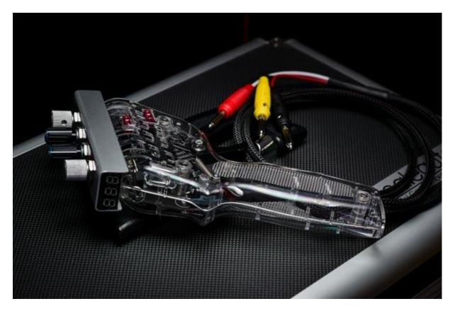
Der SLOTREGLER ist ein moderner Regler für Slotcars. Die Stellung des kugelgelagerten Fahrhebels wird berührungslos erfasst und durch einen  $\mu$ Controller in entsprechende Tastverhältnisse für die PWM-basierte Ansteuerung von Gas und Bremse umgerechnet. Durch vier Drehpotentiometer kann der Regler an die verschiedensten Fahrer, Fahrzeuge, Bahnen und sonstige Randbedingungen angepasst werden.
