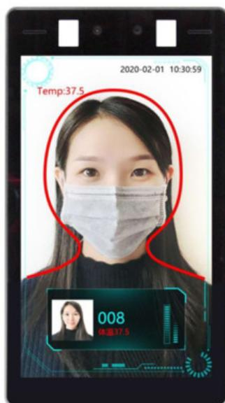
El terminal de detección térmica y reconocimiento facial Serie HA Febris TAB puede detectar temperaturas elevadas sin contacto, en este caso el dispositivo emite una alarma automáticamente.
