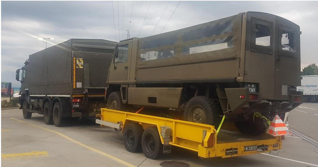
Detail Befestigung Markierwimpel für Überhang (mit Karabiner an Anhängerkupplung Duro)
