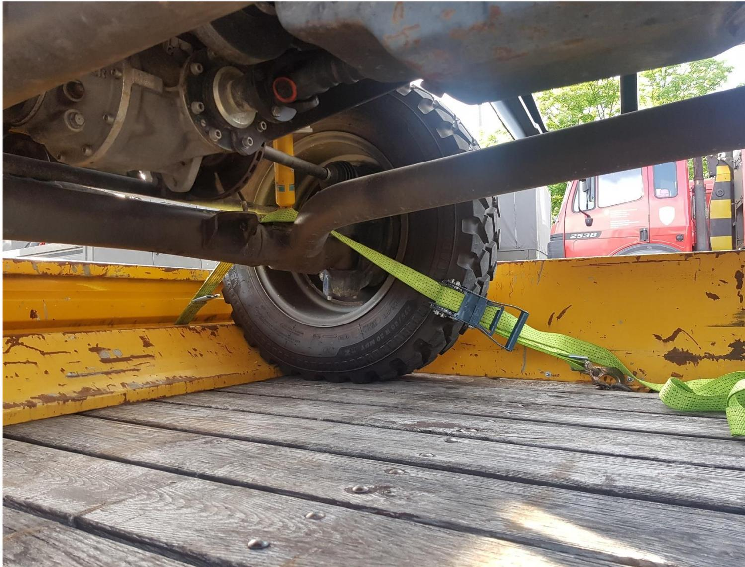
Detail Befestigung Rad Vorderachse → Kantenschutz verwenden !
