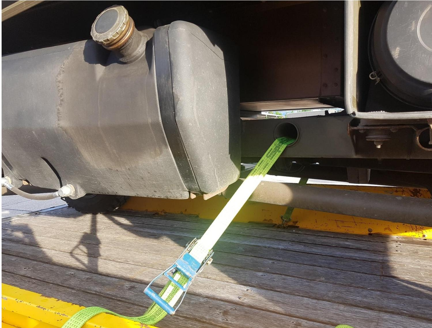
Detail Befestigung Spannset vor Tank durch Rohr → Kantenschutz verwenden !
