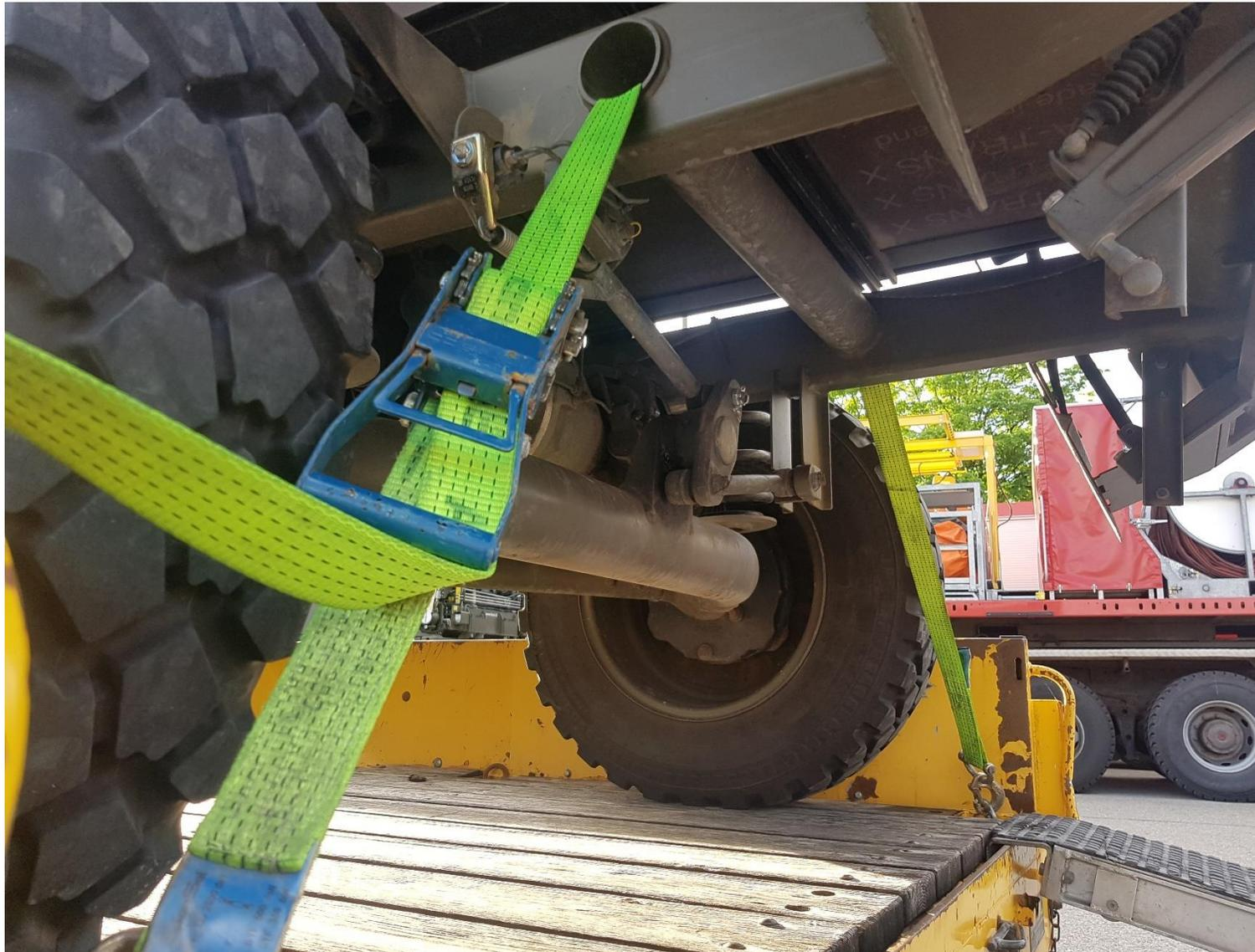
Detail Befestigung Spannsset Heck durch Rohr → Kantenschutz verwenden !
