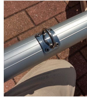
ステンレスのマストアイ とアルミマストで電蝕 リベットピンもステンレス なのでアルミのリベット ピンに交換
