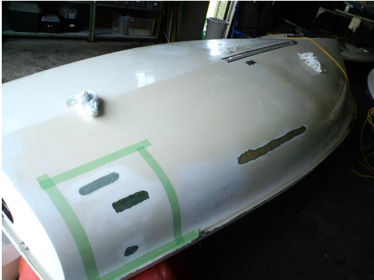
2017年7月、艇番2852ハル修理(4か所のひび割れ) 力が掛かるハルは、ガラスクロスを重ね貼りに！
