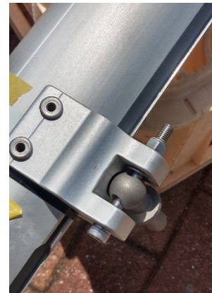
ボルト・ナットが外れなく なるので、 クレストピンに交換
