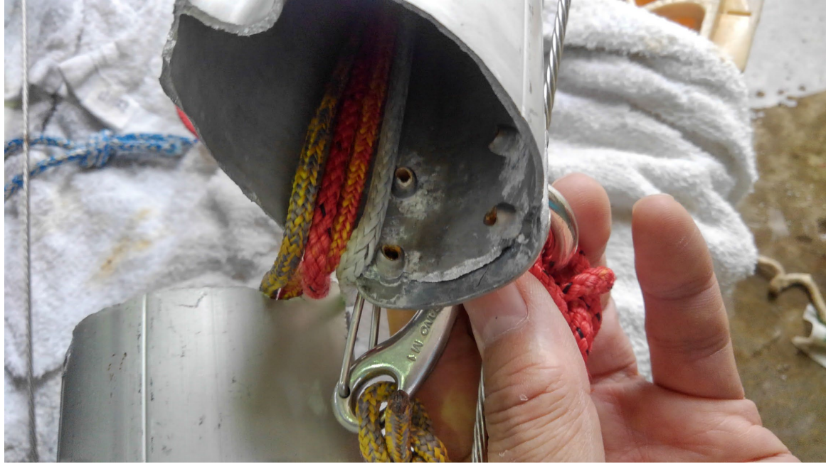
mastアイ取り付けリベットのところで 破損したmast
