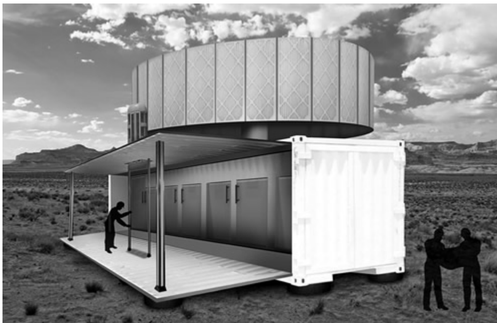
FIGURA 12.26 Ilustración de una unidad de captura del aire en un container estándar (del profesor Klaus Lackner)
