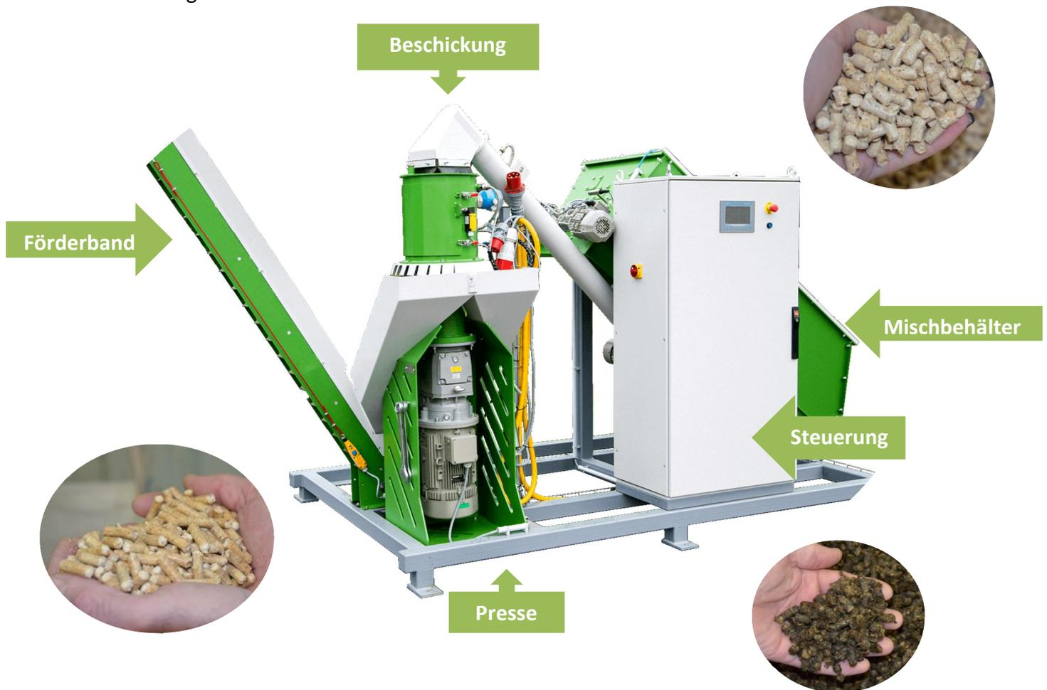
Die **Presse** ist in den Leistungsklassen 11 kW, 15 kW und 30 kW erhältlich. Unterschiedliche Matrizen ermöglichen nicht nur versch. Ausgangsmaterialien zu verarbeiten, sondern auch den Durchmesser der fertigen Pellets zu variieren und das Schüttgewicht zu beeinflussen.
