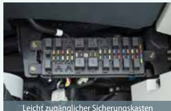
Leicht zugänglicher Sicherungskasten
