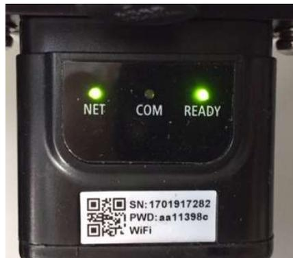
Abbildung 121 - Unregelmäßiger Kommunikationsstatus zwischen Inverter und Platine
