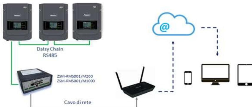
Abbildung 124 - Verbindungsschema des Datenloggers ZSM-RMS001/ M200 / ZSM-RMS001/M1000
