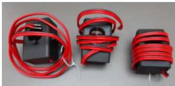
Abbildung 68 - Messgerät (oben), CT-Sensoren (unten)
