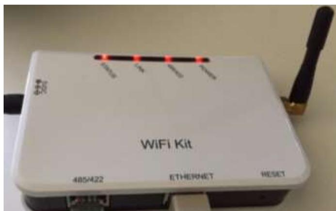
Abbildung 144 – Led, welche die korrekte Konfiguration des Datenloggers anzeigen
