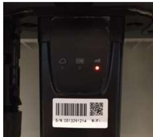
**Abbildung 106 - Unregelmäßiger Kommunikationsstatus zwischen WLAN und Remote server**
