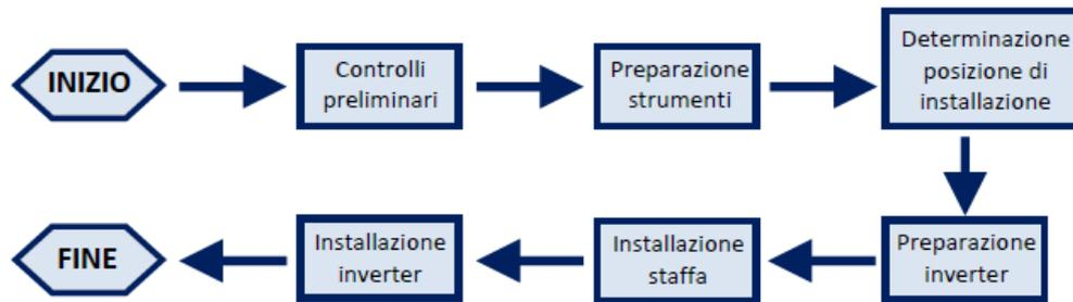
Abbildung 3 - Installationsverfahren
