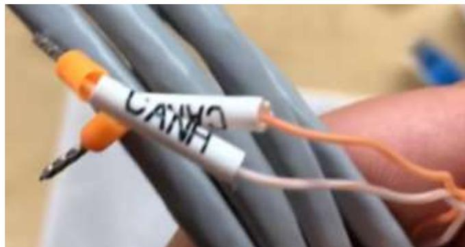
Abbildung 47 - Kommunikationskabel Inverter/HV BOX
