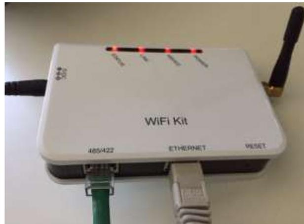
Abbildung 131 – An den Datenlogger angeschlossenes Ethernet-Kabel
