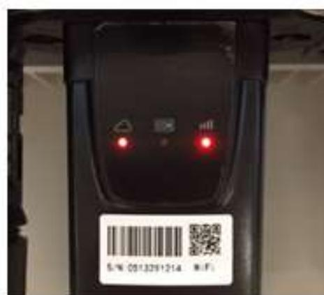
Abbildung 104 - Unregelmäßiger Kommunikationsstatus zwischen Inverter und WLAN
