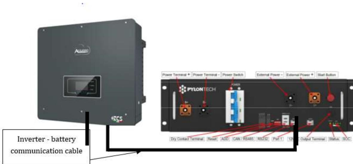
Abbildung 26 - Kommunikationsanschluss Hybridinverter und BMS
