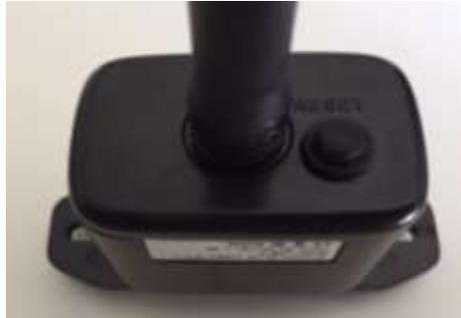
Abbildung 103 – Rest-Taste auf der WLAN-Platine
