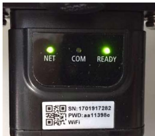
Abbildung 115 - Unregelmäßiger Kommunikationsstatus zwischen Inverter und Platine
