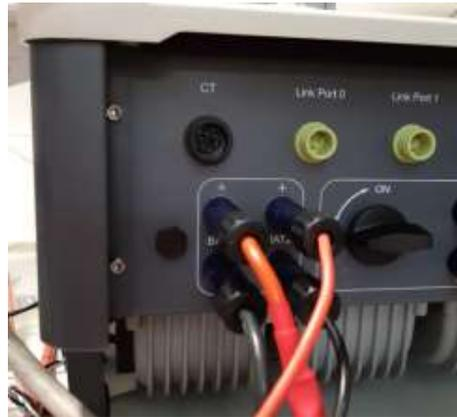
Abbildung 45 - DC-Leistungsanschluss Inverterseite mit zwei belegten Batterieeingängen
