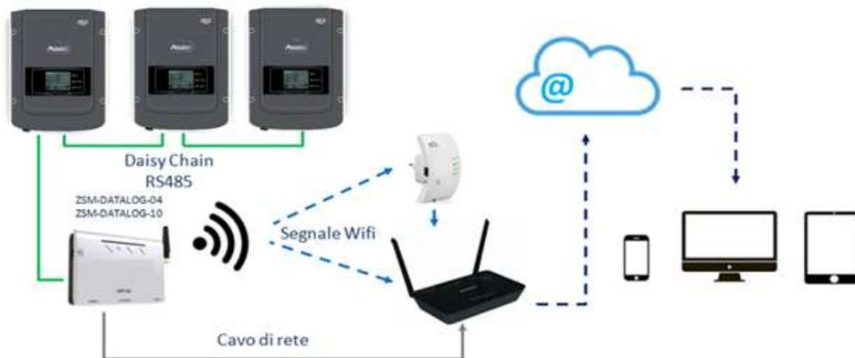
Abbildung 123 – Verbindungsschema des Datenloggers ZSM-DATALOG-04 / ZSM-DATALOG-10
