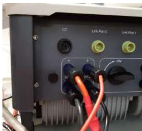
Abbildung 31 - DC-Leistungsanschluss Inverterseite mit zwei belegten Batterieeingängen
