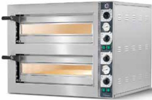
Vorderfront aus Chromnickelstahl, Backkammer alumiertes Blech, Türe Panoramaverglasung, Backkammernboden Schamott, Isolierung Steinwolle, getrennte Steuerung der Ober- und Unterhitze, Heizleistung 100%, Ober- Unterhitze jeweils 1 Heizkörper, Temperaturanzeige.
