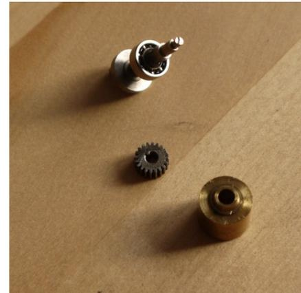
Das Getriebe des Zählwerks ist mit zwei Zahnradpaaren aufgebaut, zwischen denen jeweils ein Zahn Unterschied besteht: 20:36:50-[23-24]:26-25. Die Gruppe 23-24 läuft auf dem 50er Rad exzentrisch gelagert um dessen Achse und um die Gruppe 26-25. Die fortlaufende Verschiebung um einen Zahn pro Umdrehung bewirkt die Untersetzung zur Skalenscheibe auf dem 25er Rad, die für 25 Filmfuß nur zwei Drittel einer Umdrehung zurücklegt. Die Skalenscheibe wird mit Vierarmblatffeder verstellbar angedrückt.
