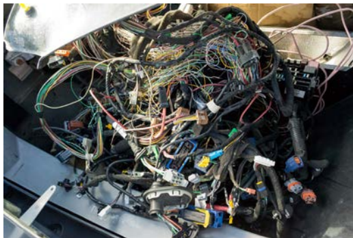
Ausgebaute Kabel eines PKWs: Die ca. 100 elektronischen Steuergeräte eines heutigen Fahrzeugs werden durch Entwicklungen wie vernetztes, semiautonomes und autonomes Fahren in Zukunft noch deutlich mehr werden.
