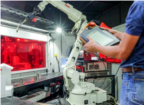
Mit 5G drahtlos gesteuerter Schweißroboter.
