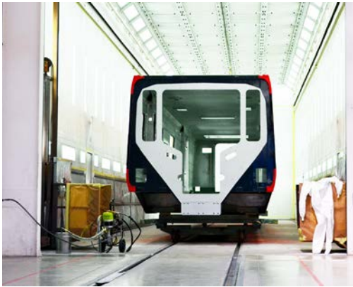
Stahl-Karosserie eines Eisenbahnwagens
