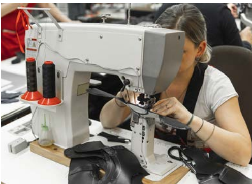
Arbeiterin an einer Nähmaschine in der Lederindustrie: Das Problem liegt im geringen Abstand zwischen Motor und Oberkörper bzw. Kopf. Dasselbe Problem haben alle Beschäftigten, die lange Zeit mit Maschinen in geringem Körperabstand arbeiten, z.B. Bandarbeiter.
