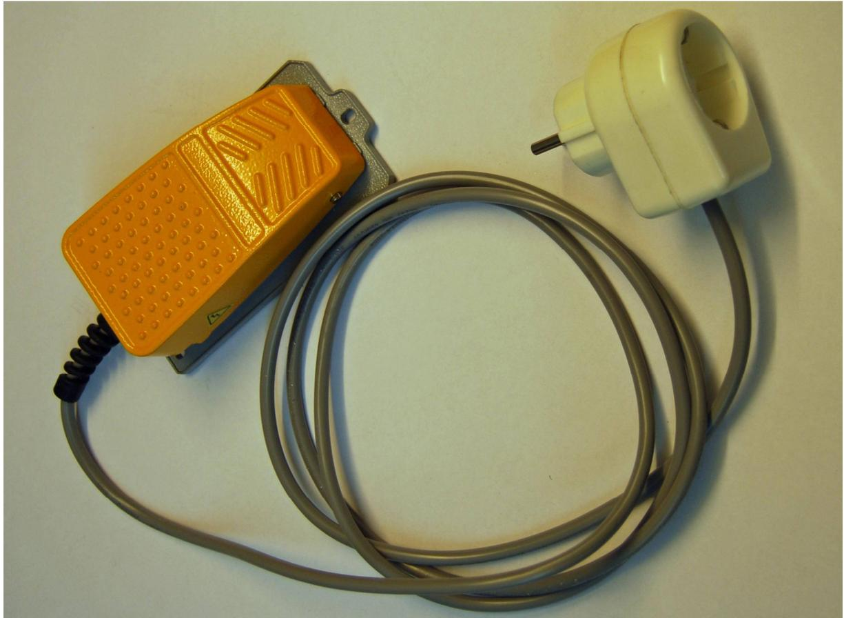
Sie benötigen einen Fußschalter 250V/16 A, einen Durchgangsstecker mit Schalterfunktion, 2 m Kunststoffleitung 3 x 1,5 mm<sup>2</sup>. Sie erhalten diese Teile im Elektronik-Versandhandel.
