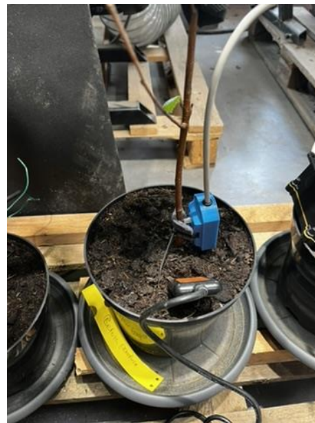
Abbildung 12: Bodenfeuchtesensor (Quelle: eigene Aufnahme 14.04.2024)
