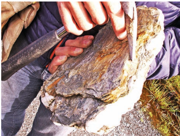
Abb. 3: Handstück eines Quarzschiefers als Beispiel eines Phyllitgesteines aus der Uttendorfer Schuppenzone.
