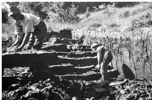
Abb. 4: Bei der Arbeit im Torfstich: Das waagrechte „Schneiden“ und das Auflegen der Torfziegel auf einen kleinen Rollwagen.
