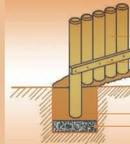
Einbauempfehlung bei unterschiedlichem Erdniveau
