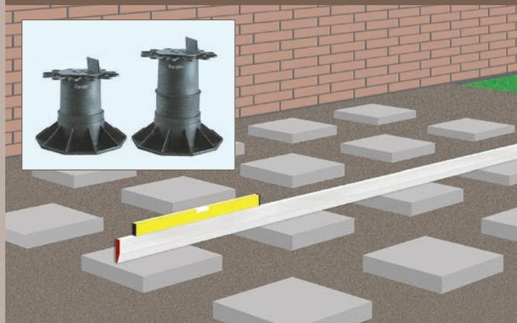
Als Fundament können Gehwegplatten oder größere Betonsteine dienen. Diese sind so auszulegen, dass ein Tragbalkenabstand von 40 bis 60 cm ermöglicht wird. Parallel zum Balken reicht ein Abstand von ca 75 cm. Es ist auf eine gleichmäßige Höhe und die Einhaltung des Gefälles zu achten. Im Fachhandel werden auch einstellbare Terrassenfüße aus Plaste angeboten. Abstände und Verlegehinweise sind dabei systembedingt.
