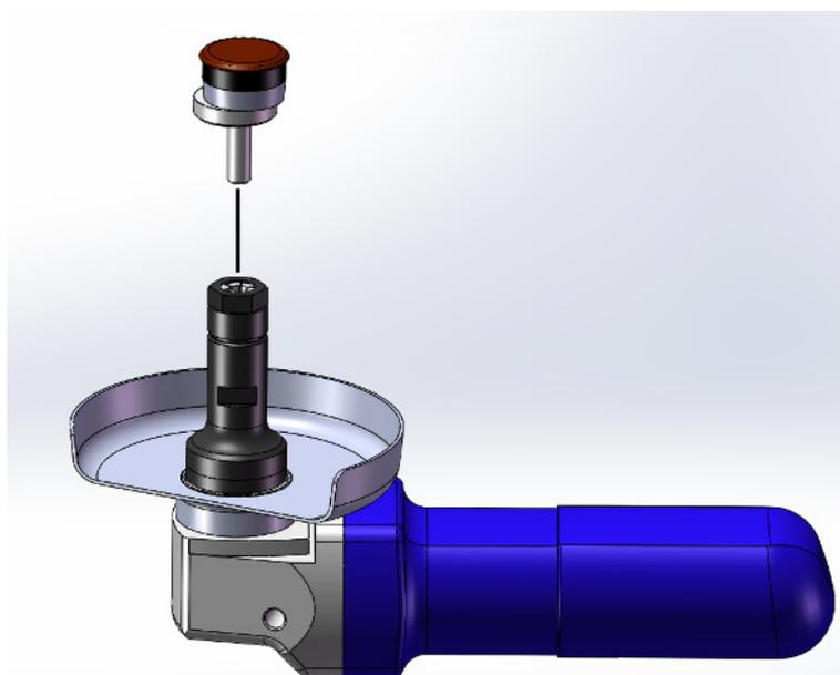
Zum Festziehen, mit Gabelschlüssel (SW 22) die Überwurfmutter nach rechts drehen und gleichzeitig mit Gabelschlüssel (SW 19) gegen halten. Zum Lösen, gleiche Vorgehensweise, jedoch Überwurfmutter nach links drehen.
